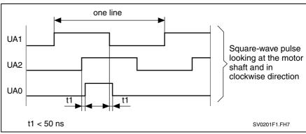
Fig. 4-127: Signal for incremental actual position value output
