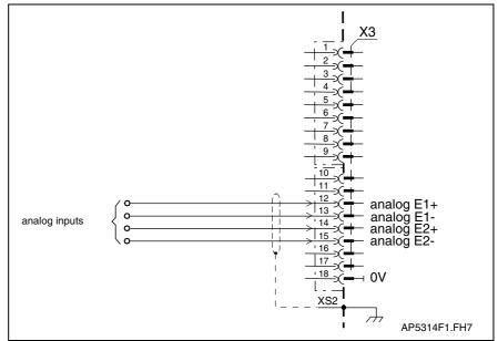
Fig. 4-76: Analog inputs
